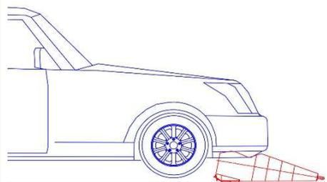
衝突した車両をロードコーンに乗り上げさせ、車両の下部に入り込むことで、車両の自重を使って路面との摩擦抵抗を高め、車両を停止させます。
